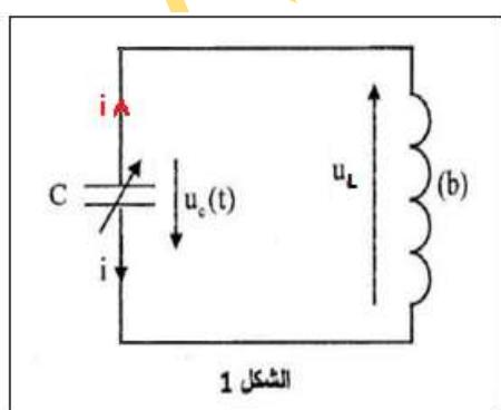
عند اللحظة  $t = 0$  لدينا :  $i = C_0 \cdot \frac{du_C}{dt}$  أي  $i = C_0 \cdot \frac{d}{dt} (C_0 \cdot \sin(\frac{2\pi}{T_0} \cdot t + \varphi))$  مع  $u_C(0) = E > 0$
